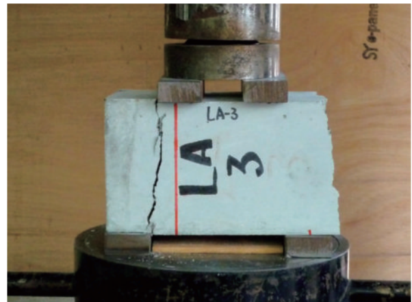
写真 2 せん断破壊状況（左せん断面）
